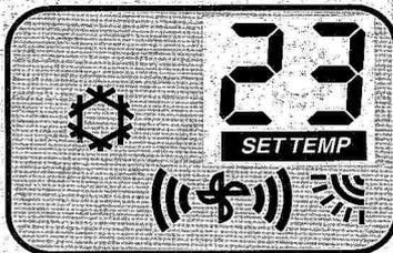
Si el sensor del aire incorporado en el Room Control está activado, al cabo de algunos segundos el display indicará la temperatura de la habitación.
